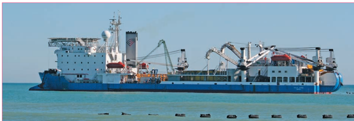
Giulio Verne: 130 m de eslora al servicio de las conexiones submarinas eléctricas y ópticas.
